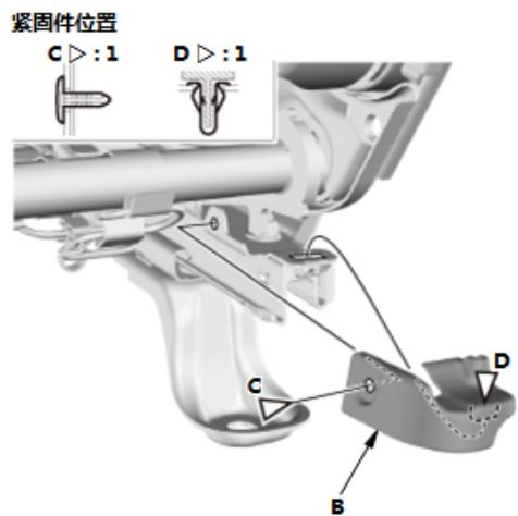
9. 所有拆下的零件 - 安装
