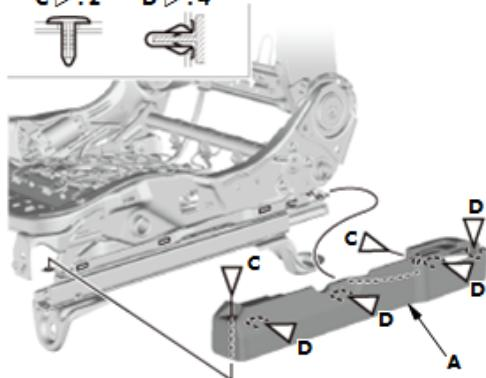
1. 拆下前排座椅上纵外护面 (A) 和前排座椅上纵内护面 (B)。
