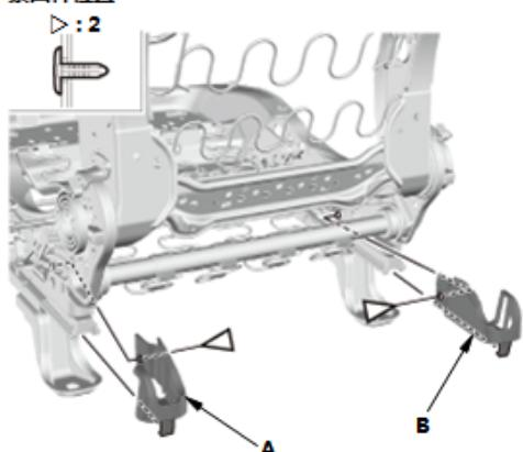
1. 拆下前排座椅高度外护面 (A) 和前排座椅高度内护面 (B)。
